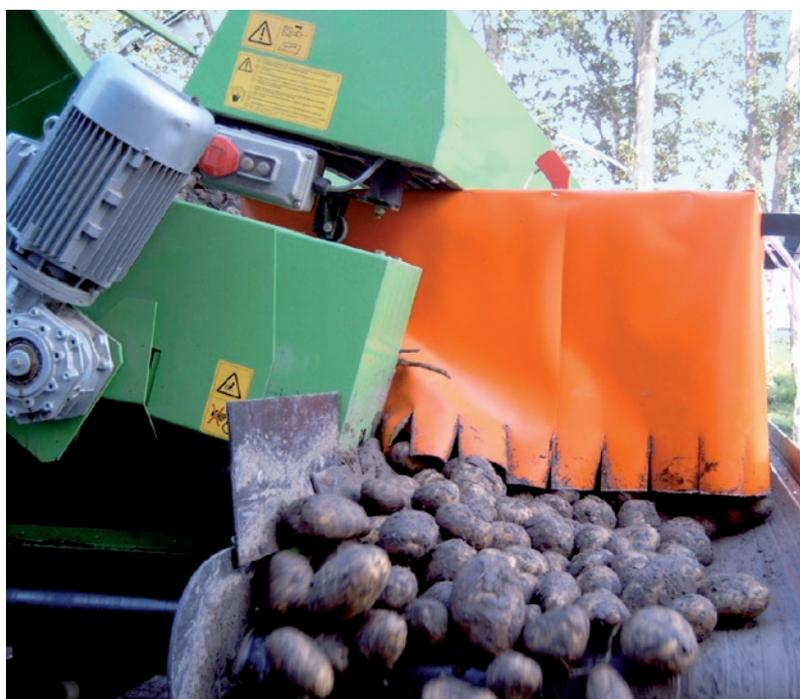
▲ Tratamiento de las patatas en la cinta transportadora (boquilla bajo la protección antisalpicaduras) ▲
